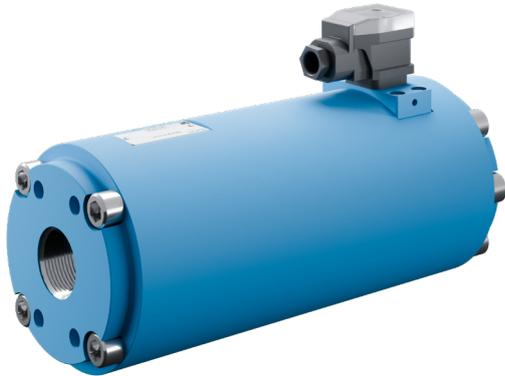
Standard-Versionen verfügen über einen integrierten Vorverstärker. Dieser wandelt die Impulse der magnetischen Sensorik in Rechtecksignale um, die anschließend von einer Auswertelektronik zu konkreten Messwerten verrechnet werden. Alternativ ist eine Version mit abgesetzter Elektronik lieferbar, die für extreme Temperaturbereiche ausgelegt ist.
