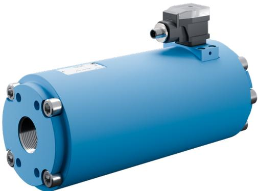
SVC-Durchflussmesser mit IO-Link-Technologie basieren auf Standard-SVCs mit zwei Sensoren. Im Gegensatz zu Versionen mit Vorverstärker, die ausschließlich ein Rechtecksignal an die Auswertelektronik liefern, sind IO-Link-Geräte zusätzlich in der Lage, intern konkrete Messwerte zu berechnen. Somit können diese Durchflussmesser sowohl in einer klassischen SPS- als auch in einer IO-Link-Infrastruktur eingesetzt werden. Detaillierte Informationen finden Sie auf Seite 14.
