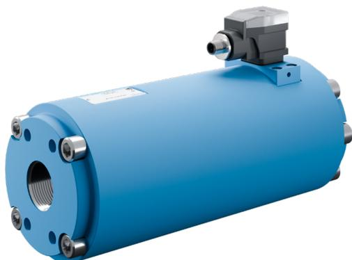
SVC-Durchflussmesser der Analog-Serie stellen ein von vielen Steuerungen und Messgeräten verarbeitbares analoges 4 ... 20 mA-Stromsignal bereit. Dabei wird das analoge Signal zur Bestimmung der Durchflussmenge genutzt. Zudem sind SVC-Geräte mit zwei Sensoren in der Lage, die Durchflussrichtung durch ein zusätzliches Digitalsignal zu übertragen. Detaillierte Informationen finden Sie auf Seite 13.
