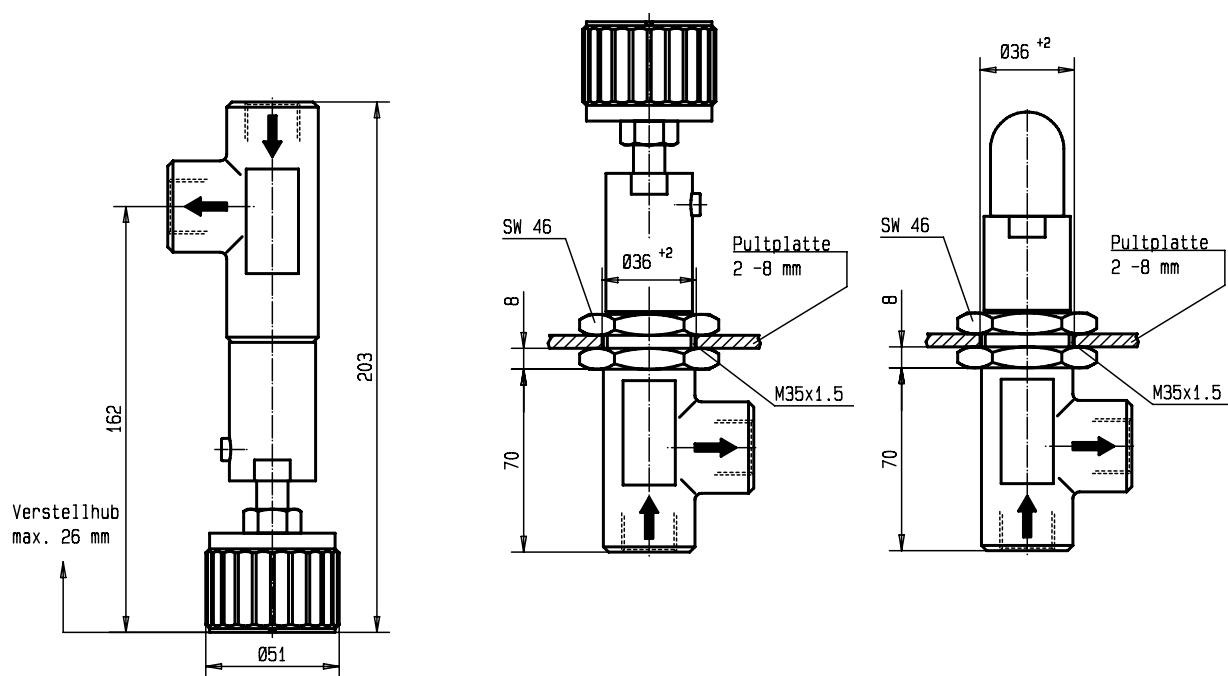
Abmessungen in mm / Gewicht: 0,9 kg
