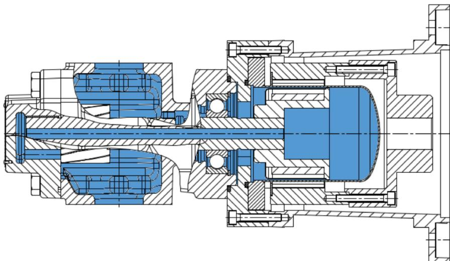
Ausführungen mit Magnetkupplung werden eingesetzt, wenn absolute Dichtheit an der Wellenabdichtung gefordert ist oder ein Betrieb mit Vordruck auf der Saugseite vorliegt. Die Magnetkupplung ist innerhalb der zulässigen technischen Grenzen leckagefrei.
