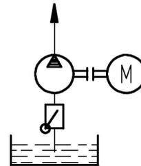
Bei Betrieb einer Pumpe, die über ein Rückschlagventil in einen unter Druck stehenden Kreislauf (z.B. Reservepumpe in einem Schmierkreislauf) fördern muss, können Ansaugschwierigkeiten entstehen, wenn die Saugleitung mit Luft gefüllt ist. In diesem Fall muss die Druckleitung unmittelbar vor dem Rückschlagventil entlüftet werden.
