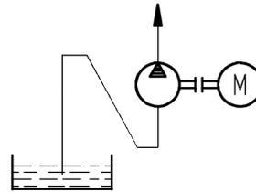
Bei längeren Saugleitungen, die während des Stillstands leerlaufen können, ist es zweckmäßig, ein Fußventil bzw. eine Rückschlagklappe einzusetzen. Diese müssen für den Einsatz in Saugleitungen konzipiert sein und einen möglichst geringen Durchflusswiderstand aufweisen.
