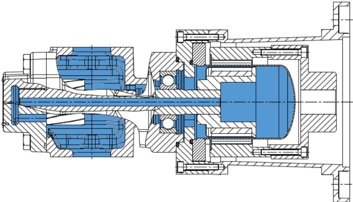
Ausführungen mit Magnetkupplung werden eingesetzt, wenn absolute Dichtheit an der Wellenabdichtung gefordert ist oder ein Betrieb mit Vordruck auf der Saugseite vorliegt. Die Magnetkupplung ist innerhalb der zulässigen technischen Grenzen leakagefrei.
