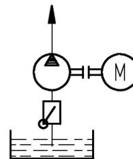
Bei Betrieb einer Pumpe, die über ein Rückschlagventil in einen unter Druck stehenden Kreislauf (z.B. Reservepumpe in einem Schmierkreislauf) fördern muss, können Ansaugschwierigkeiten entstehen, wenn die Saugleitung mit Luft gefüllt ist. In diesem Fall muss die Druckleitung unmittelbar vor dem Rückschlagventil entlüftet werden.
