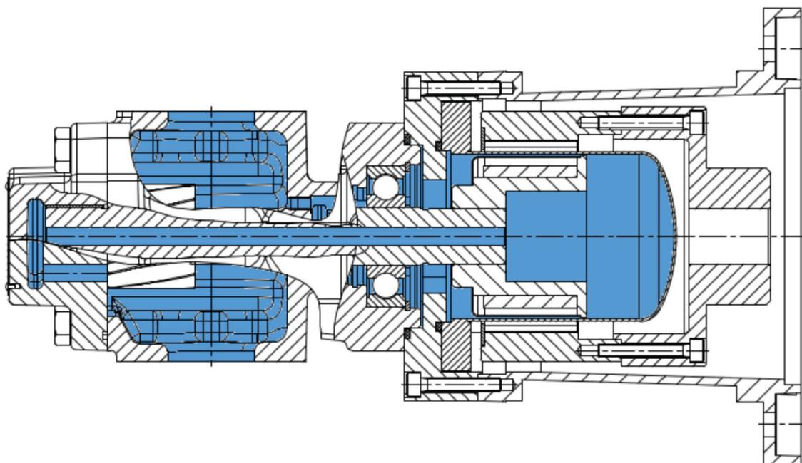
如果要求轴封处绝对密封或者如果存在抽吸侧有预压力的运行情况，则使用带磁耦合器的规格。磁耦合器在允许的技术极限范围内无泄漏。
