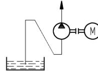
对于较长的在停止时能被排空的进口管道，有必要使用一个闸阀或一个单向阀。必须专门为进口管道中的这一应用设计脚阀或止回阀，并它们具有尽可能小的流量阻力。
