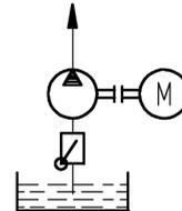
使用一台必须通过一个单向阀在受压的循环中进行输送的泵(如一台处于润滑循环中的备用泵)时，一旦进口管道中注入了空气，便可能发生抽吸困难现象。可能发生抽吸困难现象。如果没有使用排气嘴，在泵与单向阀之间的压力管道的容积至少应达到抽吸管道容积的 75%。
